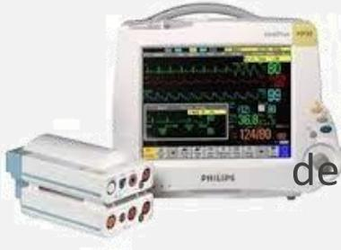
A) Moniteur patient compatible (avec un module de capnographie) et une tubulure en ligne
