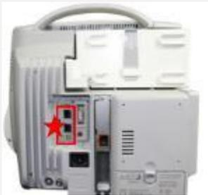
C) Connectez l'ordinateur portable/tablette au port série, USB ou MIB/RS232
